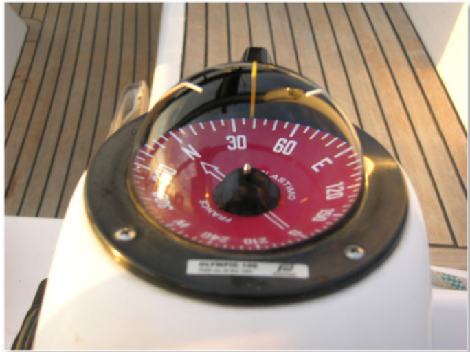
Abb.: Magnetkompass auf einer Segelyacht, MgK \approx 038°
