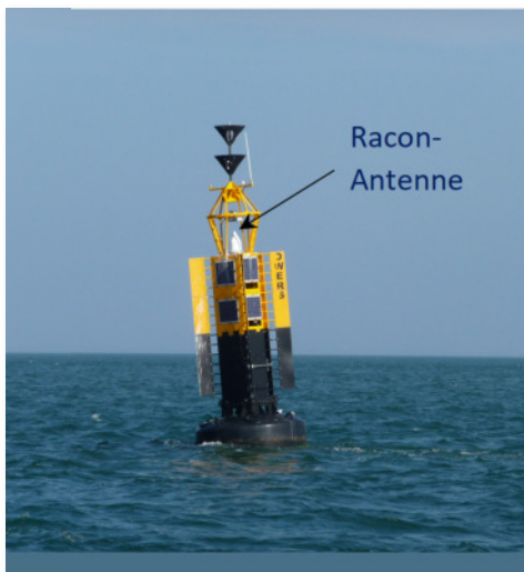
Abb.: RACON-Tonne im Englischen Kanal südöstlich der Isle of Wight: Owers YB Q(6)+LFI 15s bell RACON (O). Sie sendet 3 lange Signale, den Morsebuchstaben „O“.
