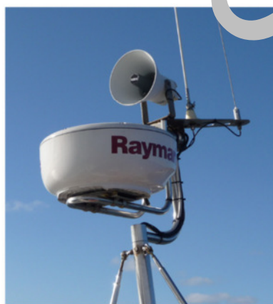
Abb.: halbkardanischer Geräteträger mit Funk-, Navtext- und Radarantenne sowie Horn
